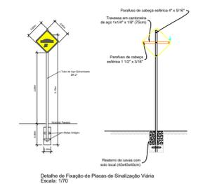
Detalhe de Fixação de Placas de Sinalização Escala: 1/10
