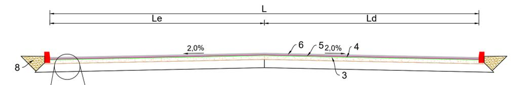
SEÇÃO TÍPICA DE PAVIMENTAÇÃO SEÇÃO BÁSICA ESCALA 1:75
