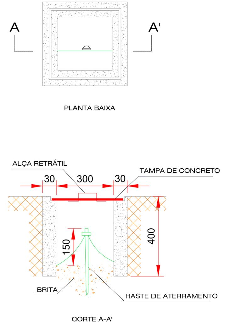
É necessário que os pontos de conexão entre os elementos do sistema de aterramento sejam necessariamente feitos através de conectores; não fazendo uso de solda exotérmica.
