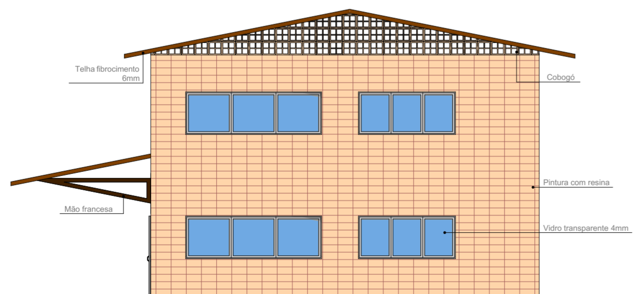
FACHADA LATERAL ESCALA: 1/100
